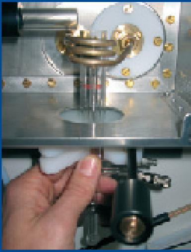
进样系统的安装非常简便。自锁式连接可确保任何时间准确定位，无需进一步调节或优化。
